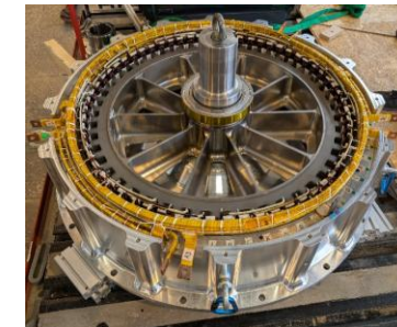
Direktantrieb Traktor 6000 Nm
